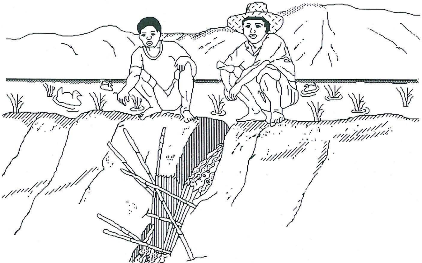
Figura 14: Al cortar una sección del dique se puede drenar y cosechar un estanque pequeño.
